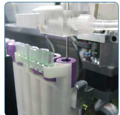
Прокалывание крышки и автоматическое разведение образца
